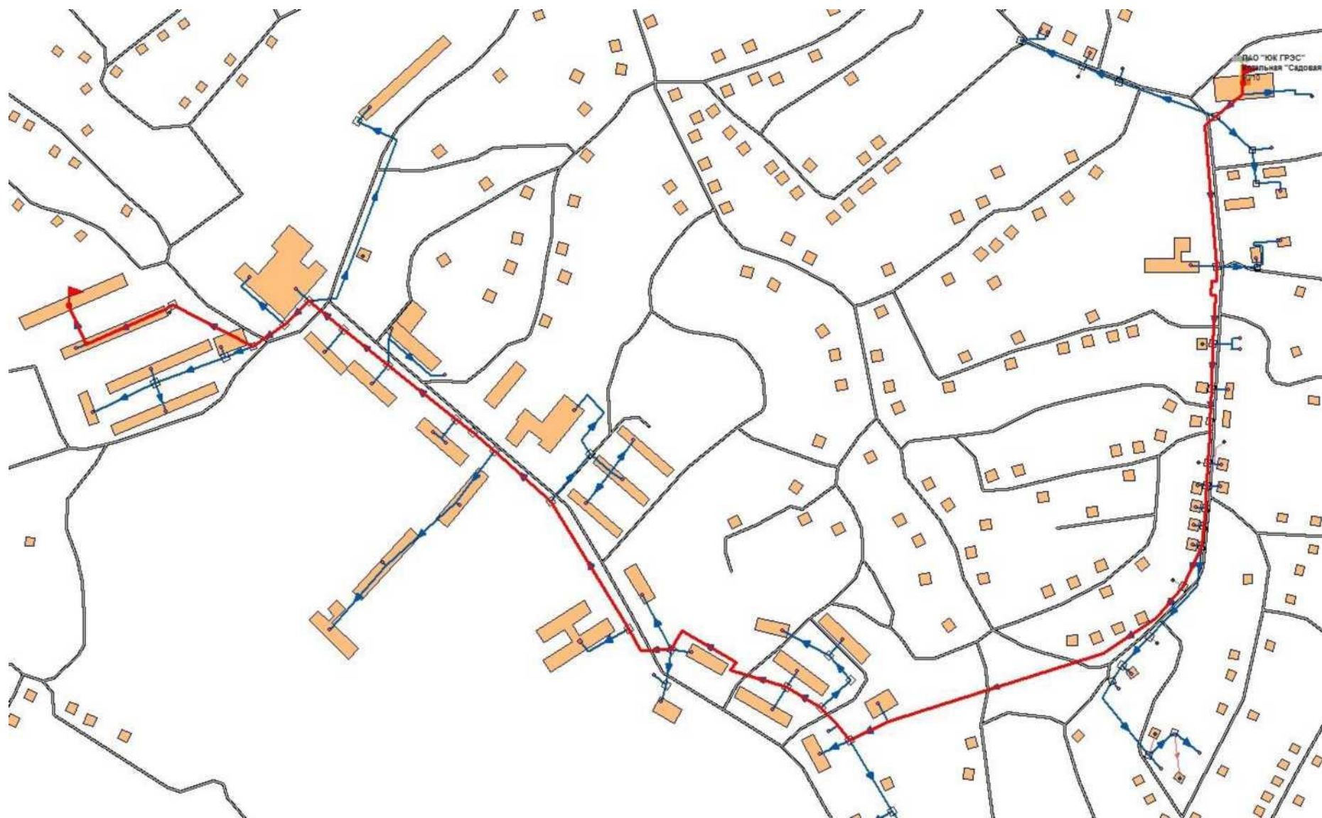
Рис. 5. Путь для построения пьезометрического графика от котельной "Садовая" до ж/д ул. 60 лет Октября, 27
