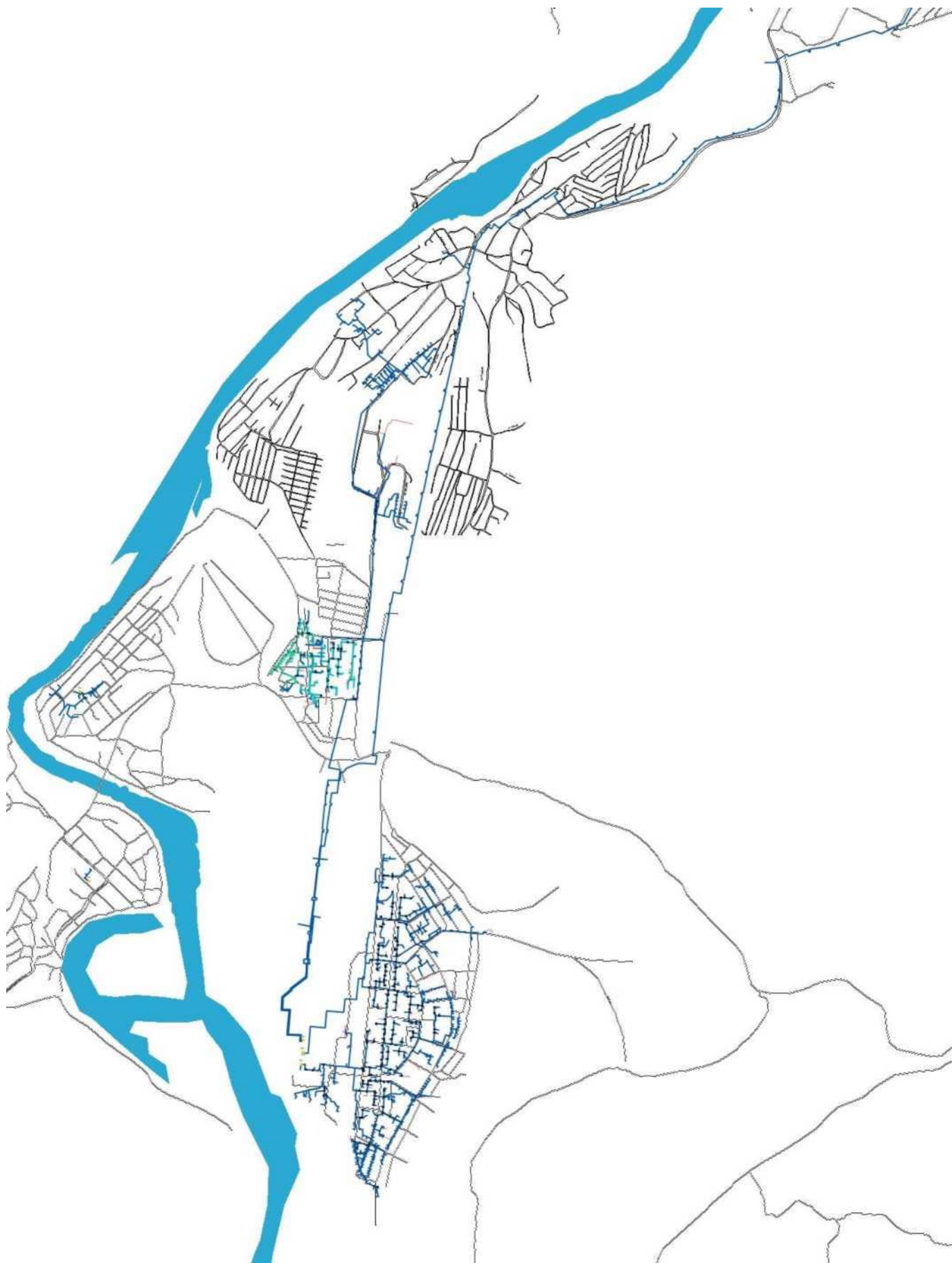
Рис. 13. Визуальное отображение структуры тепловых сетей от источников тепловой энергии Калтанского ГО
