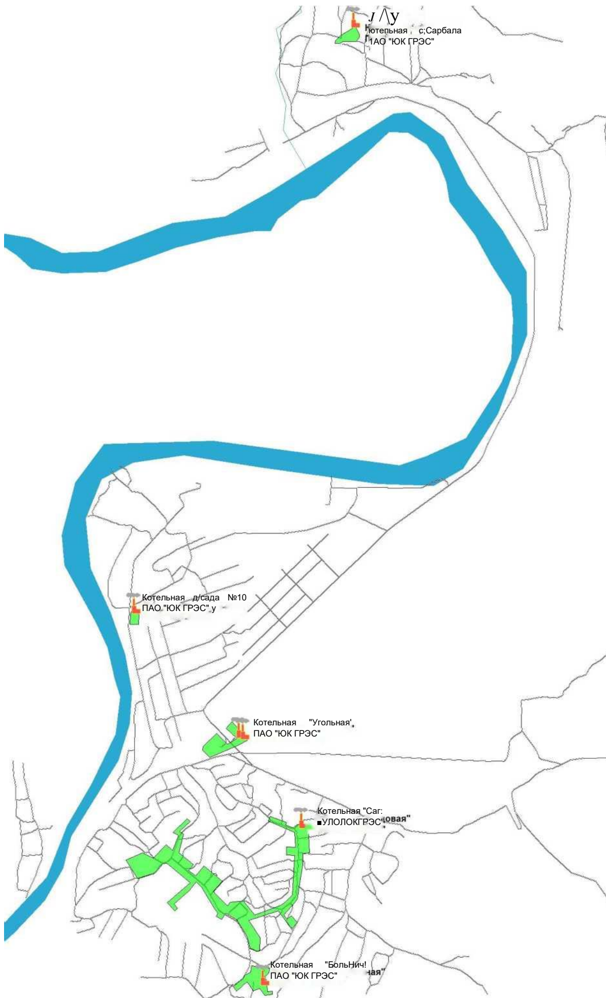
Рис. 1. Существующие зоны действия тепловых источников Калтанского ГО по состоянию на 2019 г.
